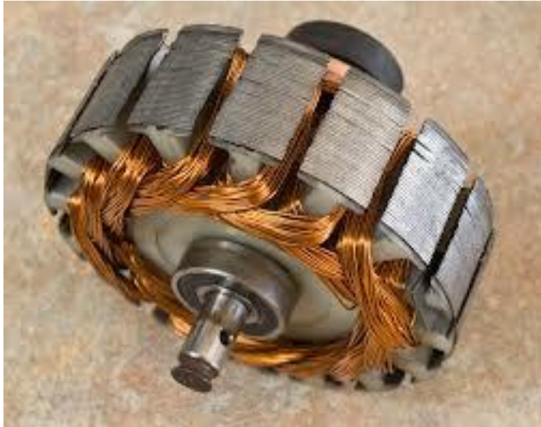
Şekil-2: Bir DC Motorun rotoru
